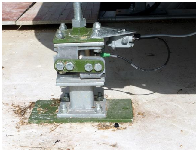
Illustration 6: pied de pesage avec cellule de pesée intégrée ; amplificateur monté sur le pied de pesage
