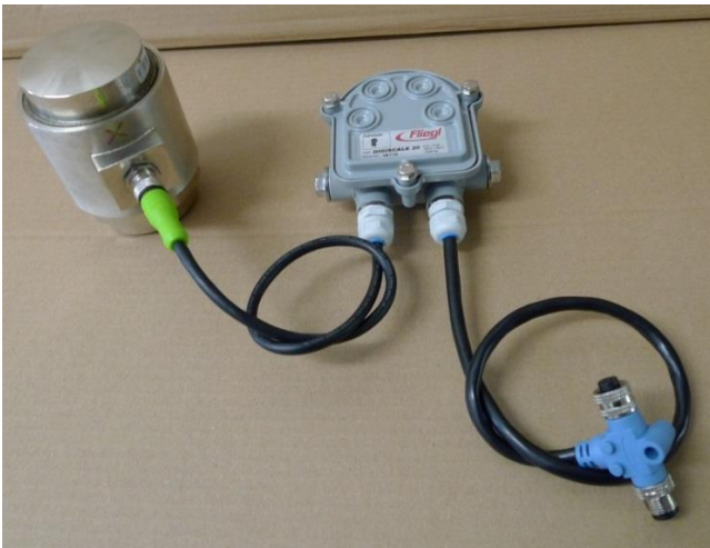
Illustration 5 : cellule de pesée analogique avec amplificateur externe
